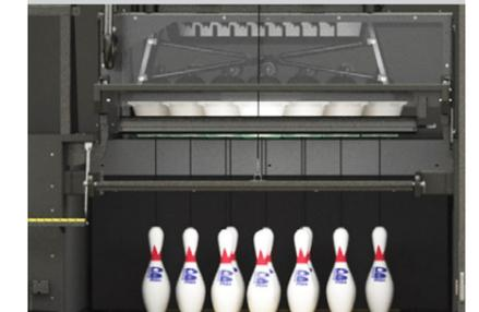
Der StrinPin Pinsetter sorgt als Seilmaschine für weniger Wartung im Center.
