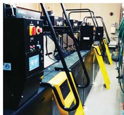
Die Mauritius Bowling in Münster hat umgerüstet: Die bisherigen 28 vollautomatischen Pinsetter wurden mit der neuesten Seilmaschinen-Generation aus dem Hause Brunswick ersetzt, den „StringPin Maschinen“.
