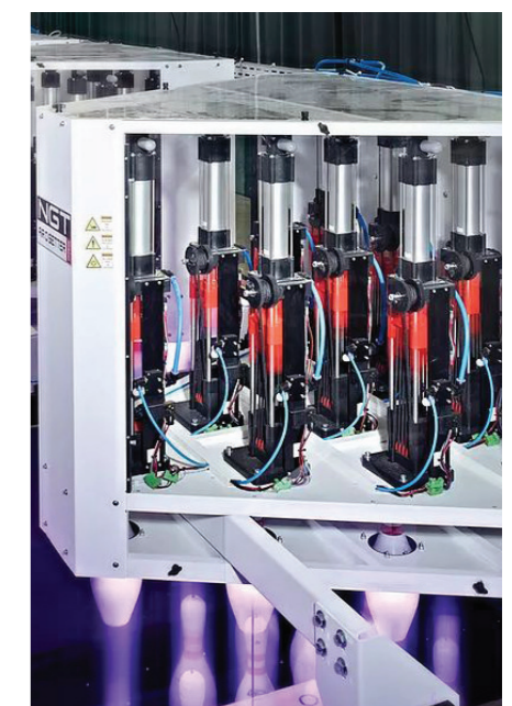
Der airO-Pinsetter von NGT arbeitet mit Luftdruck und revolutionierte damit das Aufstellen von Bowlingpins.
