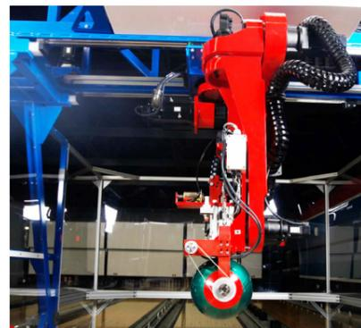
Ein Bowling-Roboter sorgte bei den USBC-Tests für exakt wiederholbare Würfe und reproduzierbare Ergebnisse.
